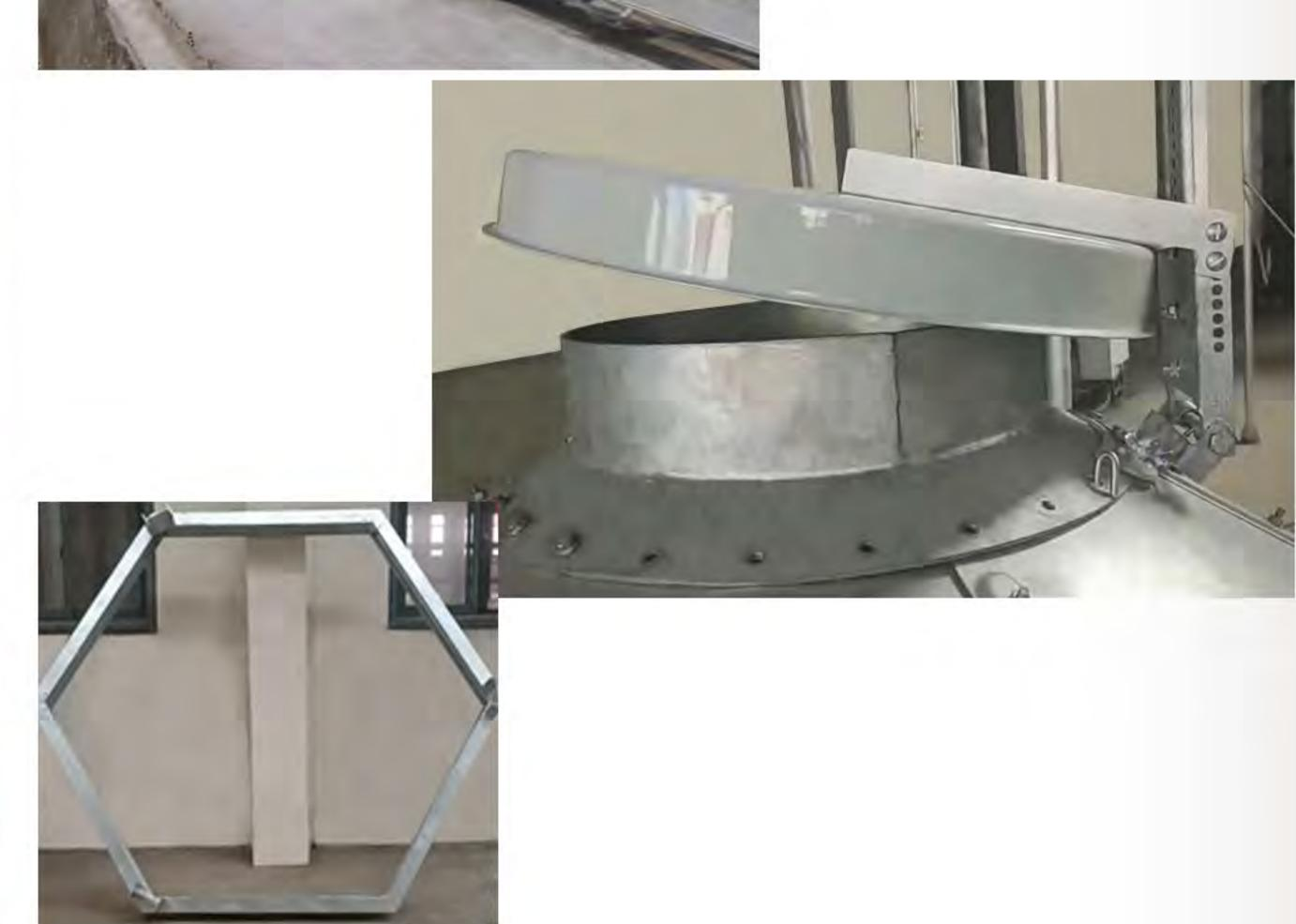
选材为双面镀锌波纹板,镀锌量275g/㎡,锌层厚度大于19μm,由上中下三层围板组装而成,料塔组装采用M10\*20高强度镀锌螺栓,除上下出口外,还配备应急打料口、观察口、透气孔(配有滤芯)、爬梯、承重框(采用H型钢HN175\*90和HN200\*100)、称重模块、自动开盖装置、阻旋料位计等,具体大小可根据客户需求定制。
